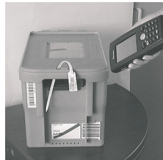
Plombaazonosító leolvasása PDA-val a lezárt és irányított egységgládáról
